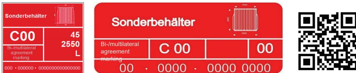
Die Daten im Schild zeigen den Profilcode und die Breite gemäß UIC 596-6 / IRS 50596-6 sowie Informationen zur Längengruppe und Nummer der bi-/multilateralen Vereinbarung (Verladebeispiel). Die Ausstellung von Kodifizierungsschildern darf nur durch befugte Stellen (Konformitätsbewertungsstelle gemäß IRS 50596-6, Anlage H.1, Tabelle 1) erfolgen.
