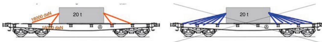
Wenn an erforderlicher Stelle keine Zurrpunkte vorhanden sind, dürfen zum Anbringen geeignete Wagenteile benutzt werden. Es ist jedoch unzulässig, die Bindemittel an Teilen des Laufwerks und der Federung, an Drehgestellen, Signalstützen, Türschließenrichtungen, Griffen, Tritten usw. anzubringen. Die Bindemittel dürfen weder die Zug-, Stoß- und Bremsenrichtungen noch das Untergestell umschlingen.
