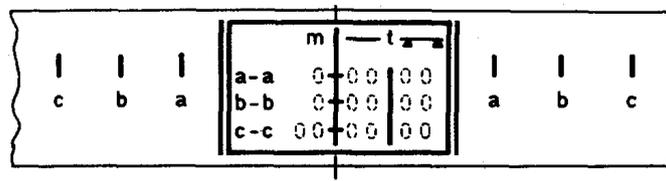
Liegen die Ladungsenden oder die Mittellinie der äußeren Auflagen zwischen zwei Markierungen, kann die zulässige Last interpoliert werden.
