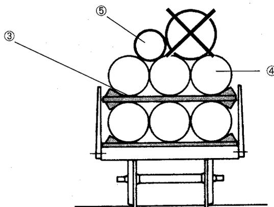
Bei Stapeln auf Flachwagen, die in Querrichtung wanken können (z.B. Baustahlmatten) sind die waagerechten Mindestabstände zwischen dem Lademaß und der Ladung gemäß Tafeln 2 zu vergrößern.
