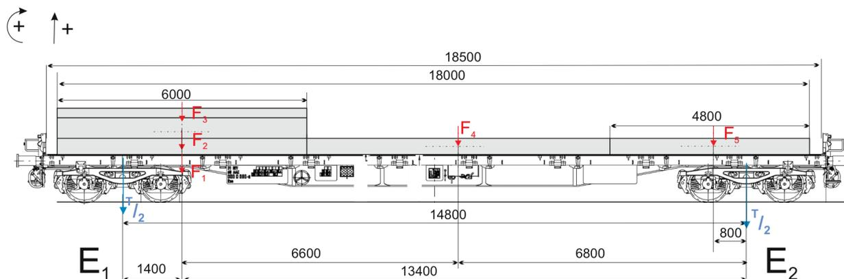
Berechnung der Einzellasten anhand der Volume und der Dichte für Aluminium 2700 kg/m<sup>3</sup>
