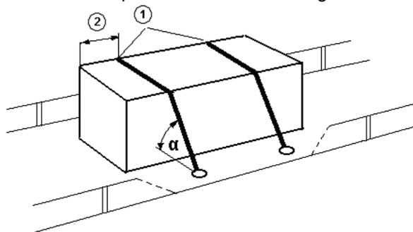
An scharfen Kanten sind die Bindemittel durch Unterlagen, Schutzschläuche oder Kantenschutzwinkel zu schützen (siehe auch Ziffer 5.4.4 ⑤).
