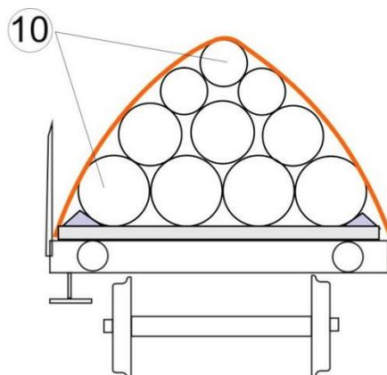
Bei gesattelt verladenen Rohren, die sich auf den Rungen abstützen, darf die zulässige Rungenbelastung nicht überschritten werden.
