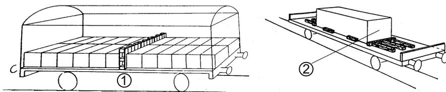
Zur Ladungssicherung kommen entweder Güterwagen mit integrierten Einrichtungen in Betracht, zum Beispiel Wagen mit verriegelbaren Trennwänden oder eine der folgenden Maßnahmen:
