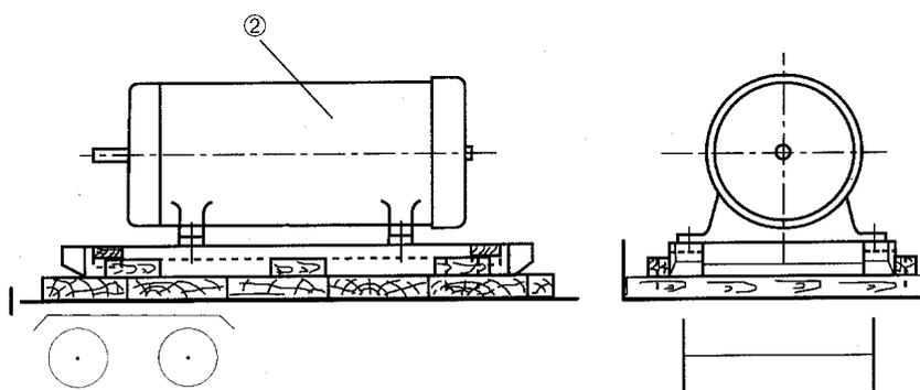
Um zu verhindern, dass die Ladeeinheiten sich in Wagenquerrichtung verschieben und dadurch das Lademaß und/oder das Radlastverhältnis von 1,25:1 überschritten wird, sind die Güter seitlich zu sichern. Ergänzend sind die Bestimmungen in Ziffern 5.4.1 und 5.4.3 zu beachten.
