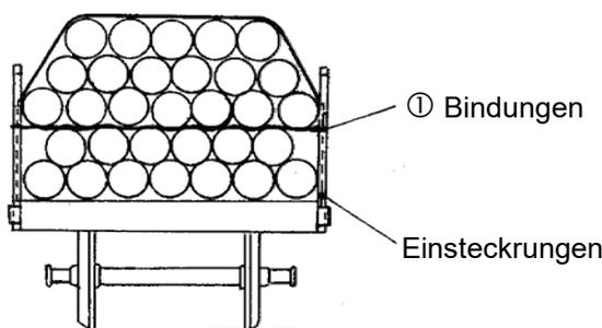
Zum Fest- oder Niederbinden einer Ladung dürfen die Rungen zur Anbringung der Bindemittel nur benutzt werden, wenn die Rungen gegen Ausheben gesichert sind.
