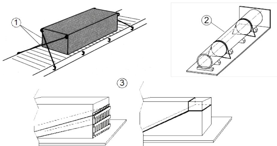
Es kann davon ausgegangen werden, dass Festbindungen in Wagenlängsrichtung ausreichend bemessen sind, wenn die Bruchkraft<sup>2)</sup> der Bindemittel in jeder Richtung insgesamt pro 1000 kg der Ladeinheit mindestens
