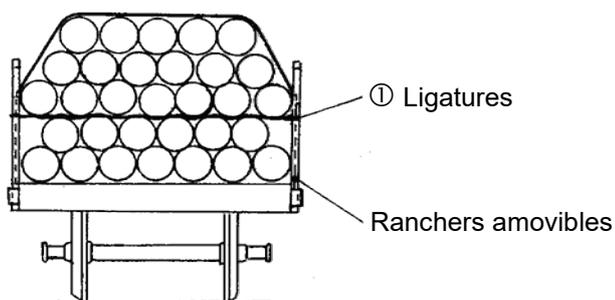
Pour l'arrimage direct ou indirect d'un chargement, les ranchers ne doivent être utilisés que pour fixer les amarres si les ranchers sont assurés contre le soulèvement.
