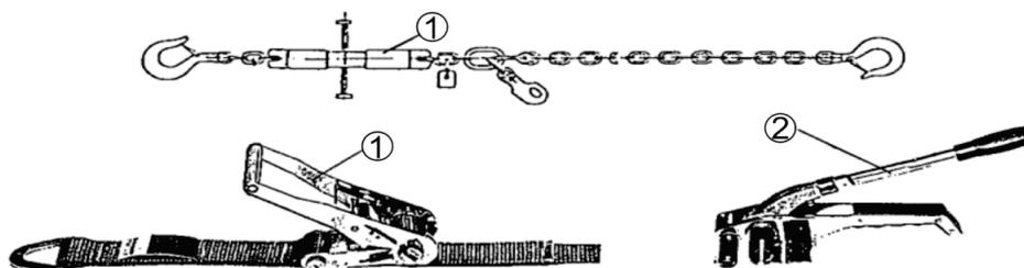
Les boucles et fermetures des sangles tissées et sangles d'arrimage de chargement doivent être adaptées au type de sangle utilisée, sous l'angle des qualités fonctionnelles et de résistance.
