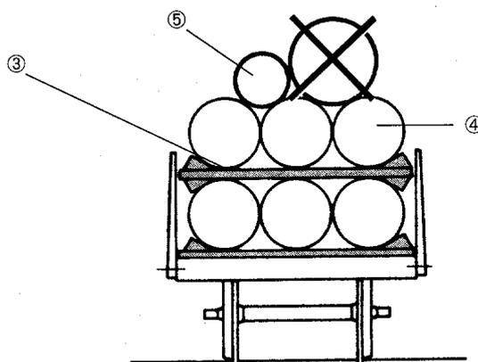
Pour les piles chargées sur wagon plat et susceptibles d'osciller dans le sens transversal (p. ex. treillis métallique), il y a lieu d'augmenter l'intervalle minimum à respecter dans le plan horizontal entre le gabarit de chargement et le chargement selon les tableaux 2.
