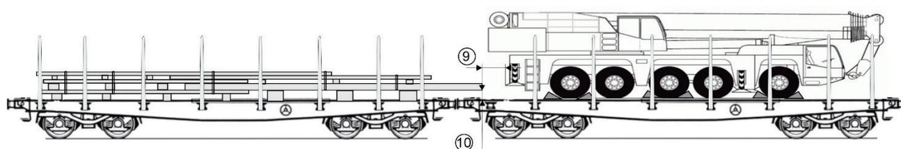
La distance verticale de 10 cm par rapport au plancher vis-à-vis du wagon de sûreté s'applique lorsque le chargement dépasse de moins de 6,5 m les essieux extrêmes ou les pivots de bogies du wagon porteur.
