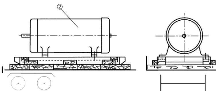
Les marchandises doivent en outre être assurées latéralement afin d'empêcher que le gabarit de chargement ne soit engagé et/ou que le rapport 1,25 à 1 entre charges par roue ne soit dépassé. De plus, les dispositions des numéros 5.4.1 et 5.4.3 sont à respecter.
