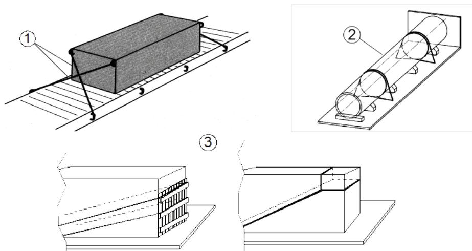
On peut considérer que les arrimages directs placés dans le sens longitudinal du wagon sont correctement dimensionnés, si l'effort de rupture<sup>2)</sup> en traction droite des ligatures dans chaque sens équivaut, pour 1000 kg de chargement, à un minimum de
