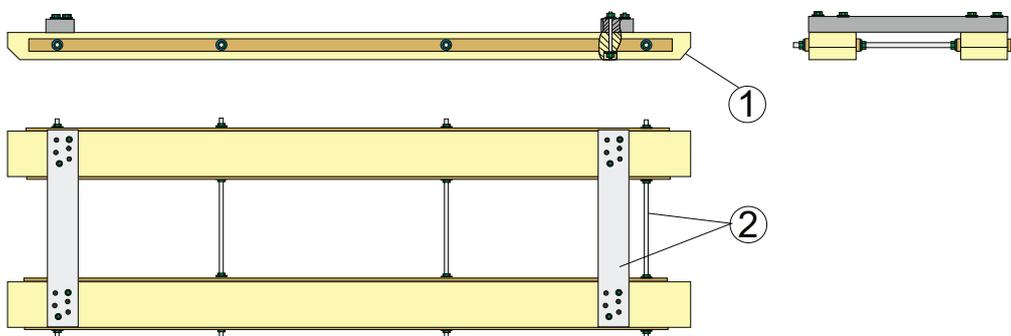
Les marchandises doivent être fixées sur des glissières ou des châssis formant traîneau de manière à ne pouvoir ni se déplacer, ni toucher le plancher du wagon.
