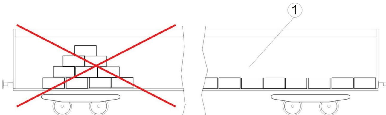
Les unités superposées doivent former des piles stables qui ne se disloquent pas, p. ex. grâce :
