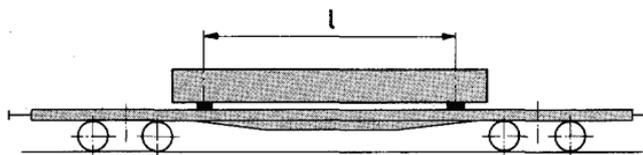
Un chargement de ce type au-delà des essieux ou des pivots de bogies n'est admissible que si des valeurs figurent dans le cartouche des charges concentrées.
