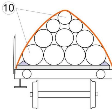
Si le chargement est constitué de tubes ou tuyaux en couches imbriquées appuyés sur les ranchers, la charge admissible sur les ranchers ne doit pas être dépassée.
