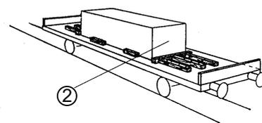
Pour arrimer le chargement, il convient soit d'utiliser des wagons à dispositifs intégrés, p. ex. des wagons à cloisons verrouillables, soit de mettre en œuvre l'une des mesures suivantes :
