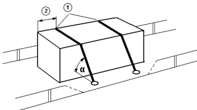
Sur les arêtes vives, les sangles doivent être protégées par des intercalaires, du caoutchouc ou des coins de protection (voir également numéro 5.4.4<sup>⑤</sup>).
